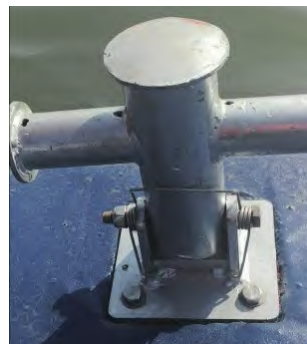
图 7 弹性支座系缆桩结构
