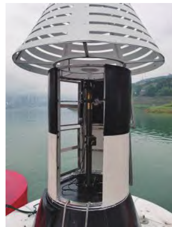
图3 柱形标多级同步升降结构
