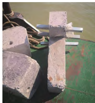
图 6 耙齿状锚石结构
